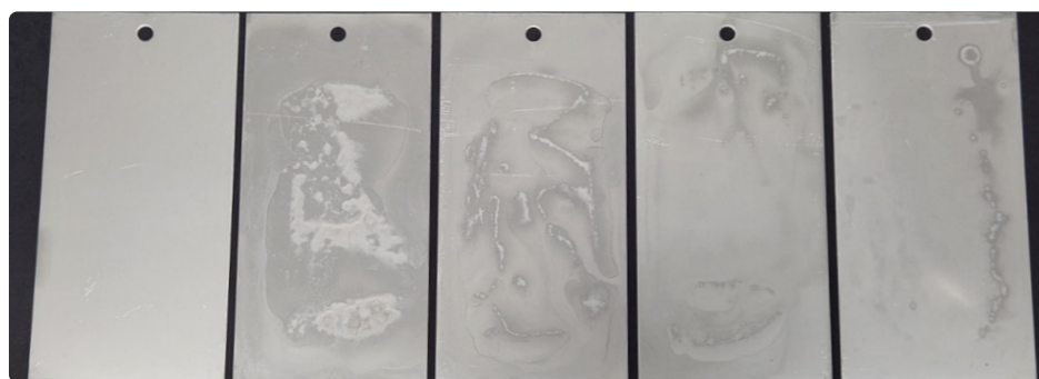
Figura 2. A simeticona foi limpa com detergente ProKlenz ALIGN 1% v/v a 45 °C por imersão agitada durante 15 minutos. Os detergentes concorrentes foram usados a 1% v/v a 45 °C por imersão agitada, resultando em falha visual após uma hora de limpeza.
