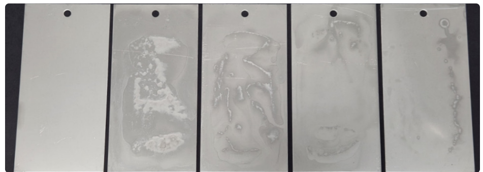
Figura 2. Residui di simeticone puliti con Detergente ProKlenz ALIGN all'1% v/v a 45 °C mediante immersione con agitazione per 15 minuti. L'uso di detergenti della concorrenza all'1% v/v e a 45 °C mediante immersione con agitazione ha determinato un risultato negativo all'ispezione visiva dopo un'ora di pulizia.
