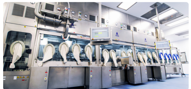
Válvula ChargePoint AseptiSafe® Bio integrada ao processo isolador da Evonik
